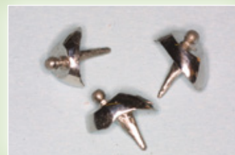
Monofusione: perno cappuccio e sfera fusi. Oltre al parallelismo le sfere sono in posizione sfasata rispetto all'asse del perno
