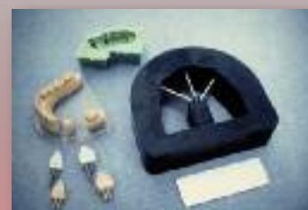
Duplicazione dei monconi in rivestimento con perni in ceramica e muffola speciale
