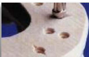
Esecuzione dei fori sulla foragessi Pindex Esecuzione dei tagli per perni doppi e tripli
